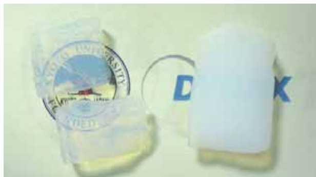
図1 湿潤ゲル(左)と超臨界乾燥後(右)のゲルの外観。それぞれ左がカチオン性界面活性剤、右が非イオン性界面活性剤を用いて作製された試料。
