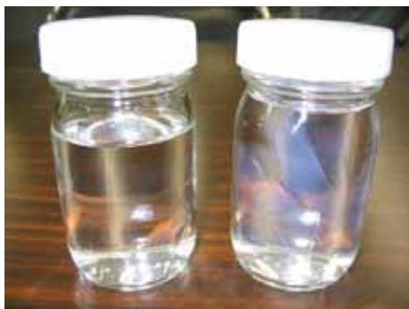
図1 湿潤ゲル(左)と超臨界乾燥後(右)のゲルの外観。それぞれ左がカチオン性界面活性剤、右が非イオン性界面活性剤を用いて作製された試料。
